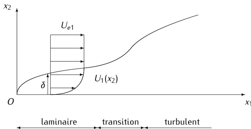
Développement d'une couche limite sur une plaque plane sans gradient extérieur de pression. La transition se produit pour  $Re_{x_1} = x_1 U_{e1} / \nu \simeq 3.2 \times 10^5$ , soit encore pour  $Re_\delta = \delta U_{e1} / \nu \simeq 2800$ .
