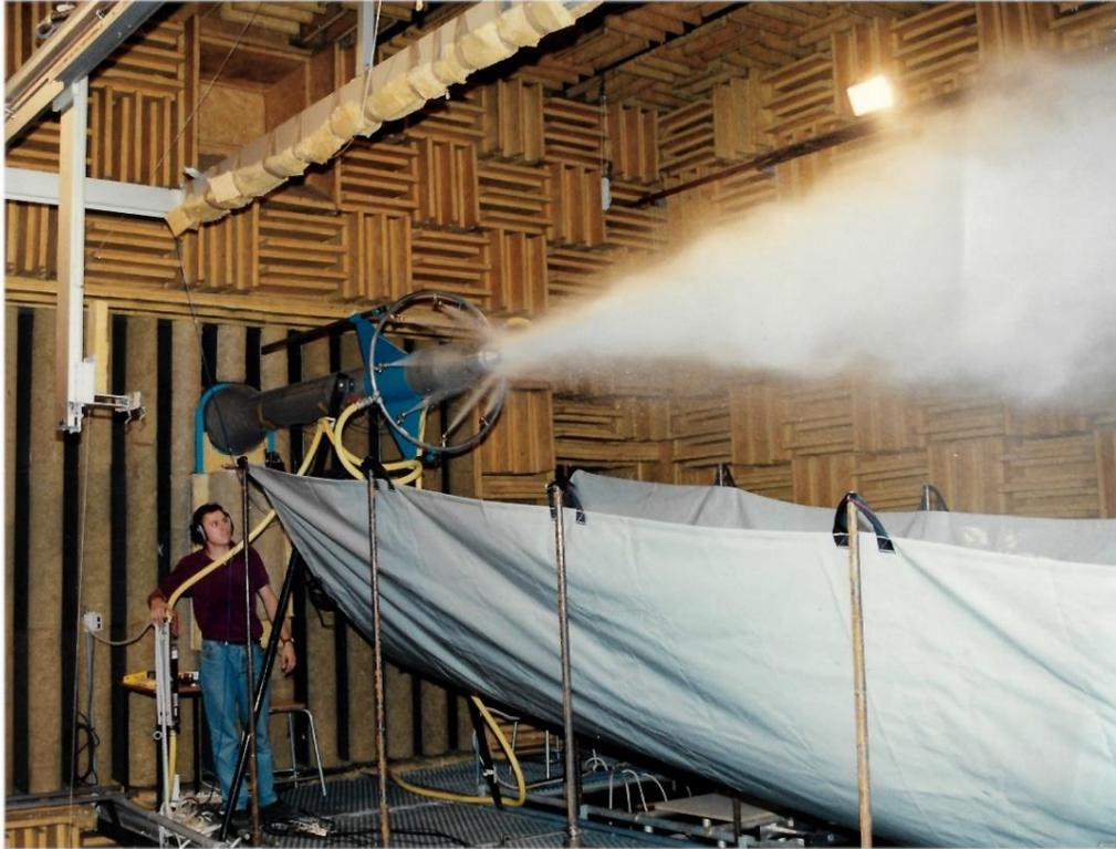
**Guide d'écoulement** « transparent aux ondes acoustiques »; Deufrako 1996, collaboration SNCF/Alstom/DB ...
