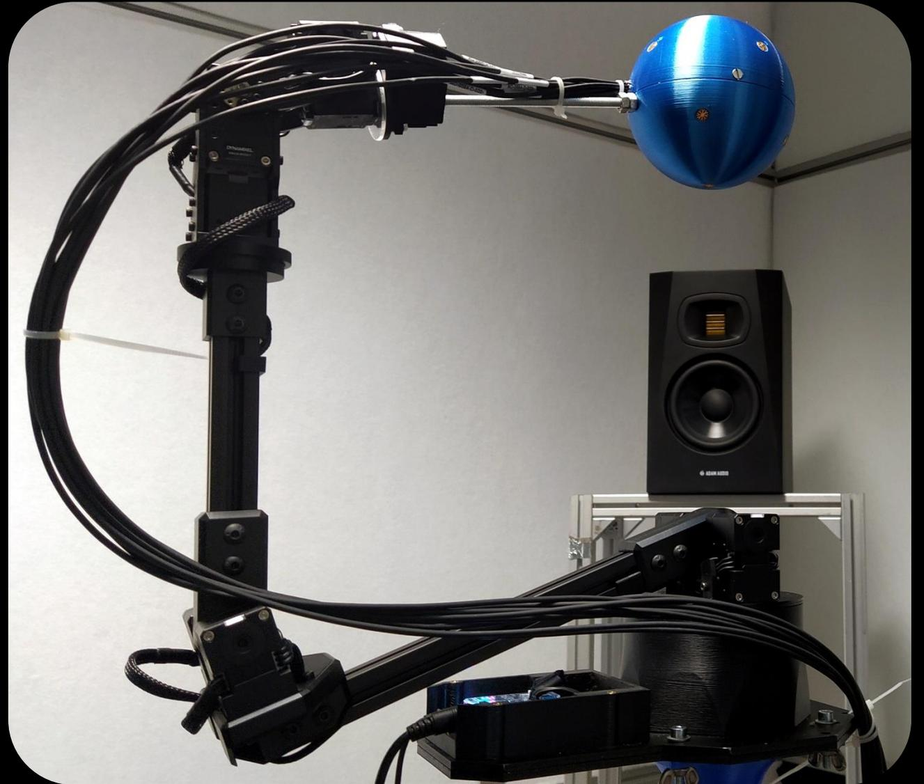
**Des arrangements sphériques de microphones peuvent être utilisés pour faire des enregistrements audios, afin de recréer des environnements sonores 3D par des méthodes de traitement du signal.**
