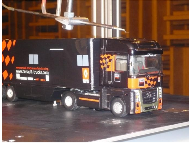
Mesures au fil chaud autour d'une maquette de camion
