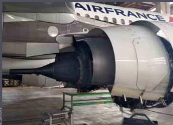
Le « plug ARCOCE », un cône d'éjection en composite à matrice céramique, a effectué son premier vol en 2015 sur un A320.
