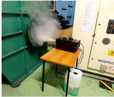
Fig. A.39 Ensemenceur utilisé pendant les mesures par PIV pour l'écoulement secondaire.
