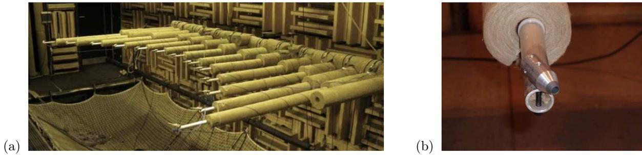
Fig. A.2 (a) Antenne polaire de directivité en champ lointain, (b) détail du support des microphones.
