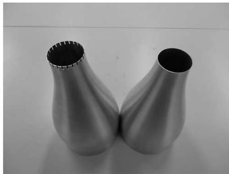
Fig. 2.3 Photographie des deux tuyères convergentes utilisées : crénelée à gauche et lisse à droite.
