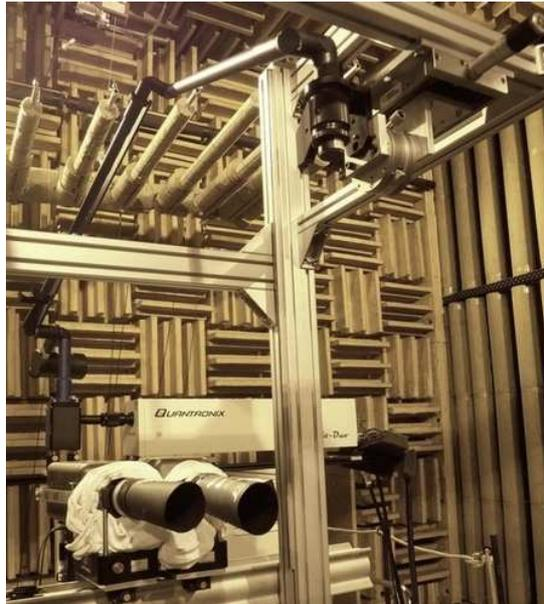
Fig. A.34 Montage pour la PIV. On distingue le laser, le bras optique menant à la tête d'émission et les deux caméras avec caches.
