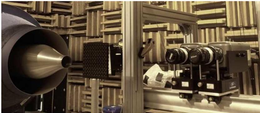
Fig. A.35 Caméras rapides fixées sur les montures Scheimpflug et pointant vers la mire.
