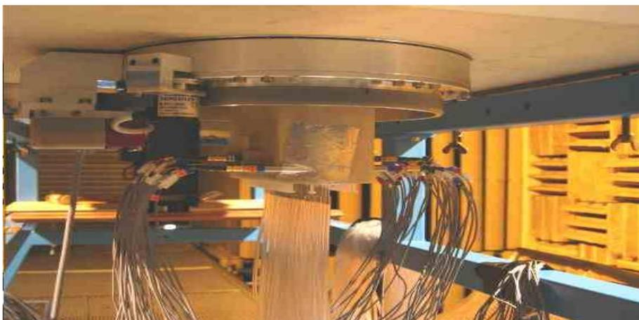
FIG. 2.6 – *Vue du système de motorisation de l'antenne de mesure.*
