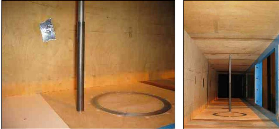
FIG. 3.25 – Photographies de la veine d’essai équipée du barreau.
