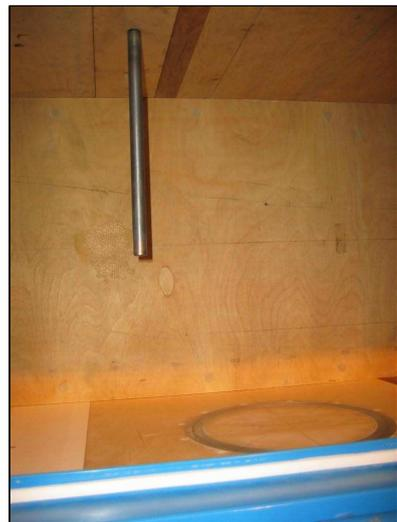
FIG. 3.1 – Photographies de la veine d'essai équipée du dispositif d'injection de l'onde acoustique.
