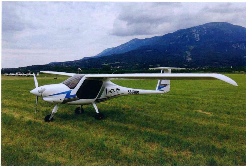
Fig. 3 : Le Pipistrel Velis Electro est le premier avion électrique certifié au monde, destiné à la formation des pilotes.
