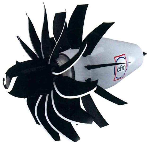
Fig. 4 Projet OFELIA (Open Fan for Environmental Low Impact of Aviation) coordonné par Safran Aircraft Engines de soufflante non carénée, actuellement testée en soufflerie pour l'aérodynamique et l'acoustique par l'ONERA à Modane-Avrieux (Savoie).
