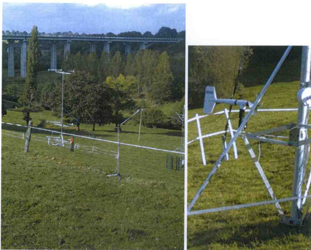
FIG. D.1 – Photographies du mât météorologique et d'un microphone (à gauche) et d'une girouette (à droite).
