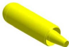
FIG. IV.26 – CAO du conduit d’éjection avec corps central émergent.
