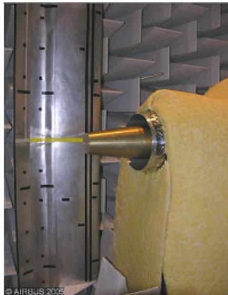
FIG. III.36 – Surface portante en configuration braquée dans la chambre sourde.
