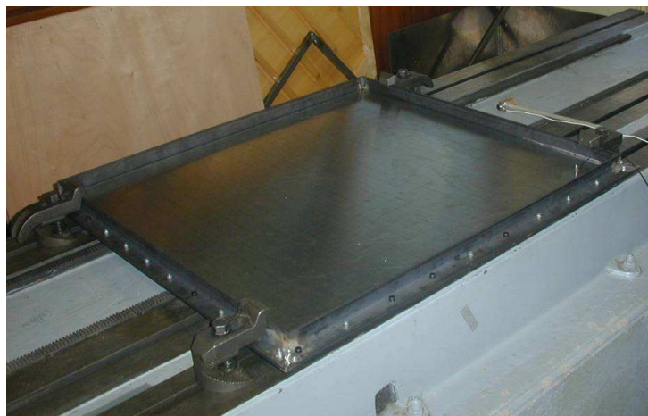
Figure 2.7: La plaque seule serrée entre le cadre et le contre-cadre
