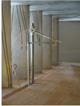
(a) Photographie du Pitot coudé et du fil chaud en amont des bords d'attaque
