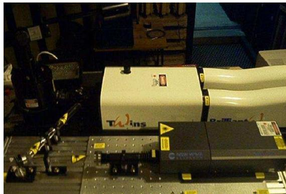
FIG. 3.2: Système de couplage des lasers.
