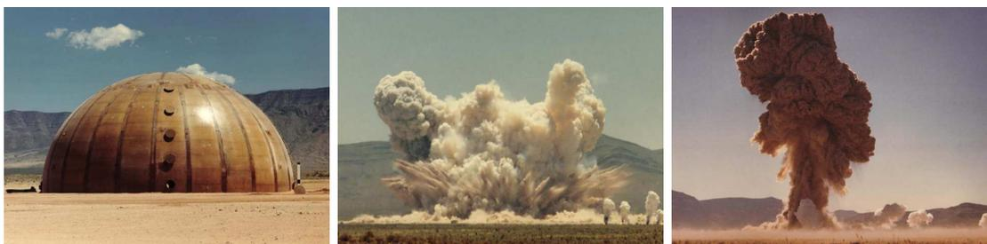
FIGURE 4.1 – Photos de l'expérience Misty Picture. La première photo représente la demi-sphère en fibre de verre contenant l'ANFO. Les autres photos montrent le nuage de poussière généré par l'explosion.
