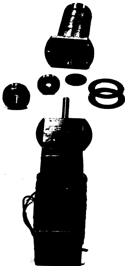
Fig. 4. Vue des constituants du générateur.
