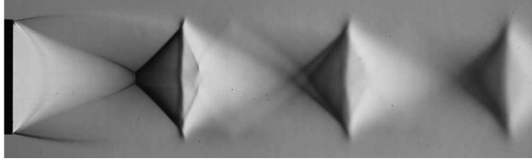
FIGURE 1.1 – Image schlieren moyenne d'un jet supersonique sous-détendu caractérisé par un nombre de Mach d'éjection de \mathcal{M}_e = 1 , un nombre de Mach parfaitement détendu de \mathcal{M}_j = 1.5 et un nombre de Reynolds de 10^6 , d'après André [2].
