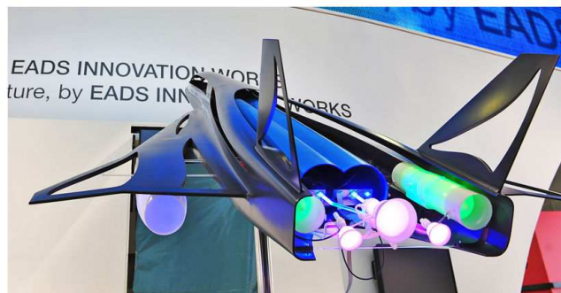
FIGURE 1 – Projet d'avion supersonique du groupe Airbus : le ZEHST au salon du Bourget en 2011. Les turboréacteurs, les moteurs-fusées et les statoréacteurs sont représentés en bleu, rose et vert, respectivement.
