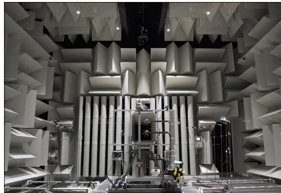
Fig. 5 : La chambre anéchoïque actuelle et les sections de sortie des souffleries subsonique et supersonique Internal view of the anechoic chamber and of the exhausts of the subsonic and supersonic wind tunnels
