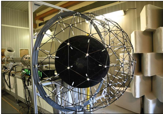
Fig. 6 : Vue partielle du banc LP3, mettant en évidence le réseau externe de 89 microphones (la demi sphère noire est l'écran anti-turbulence (TCS) poreux destiné à régulariser l'écoulement entrant dans la machine Partial view of the LP3 test bench, with emphasis on the 89 microphone external array. The black half porous sphere is a Turbulent Control Screen (TCS) used to reduce incident fluctuations in the sucked flow
