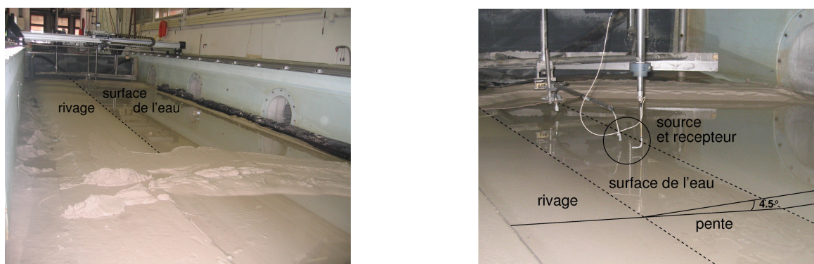
FIG. 2.17 – Modèle expérimental du guide d'onde à fond incliné présentant une pente d'environ 4.5°.
