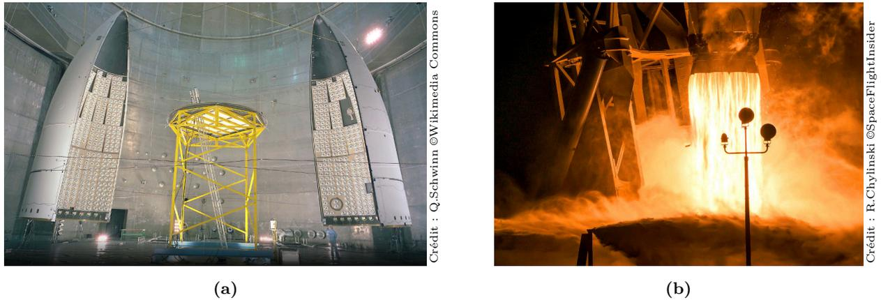
**Figure 2:** réduction du bruit et protection de la charge utile au décollage ; (2a) intérieur de la coiffe du lanceur Ariane 5 et (2b) déluge d'eau sur la table de lancement au décollage du Falcon 9.
