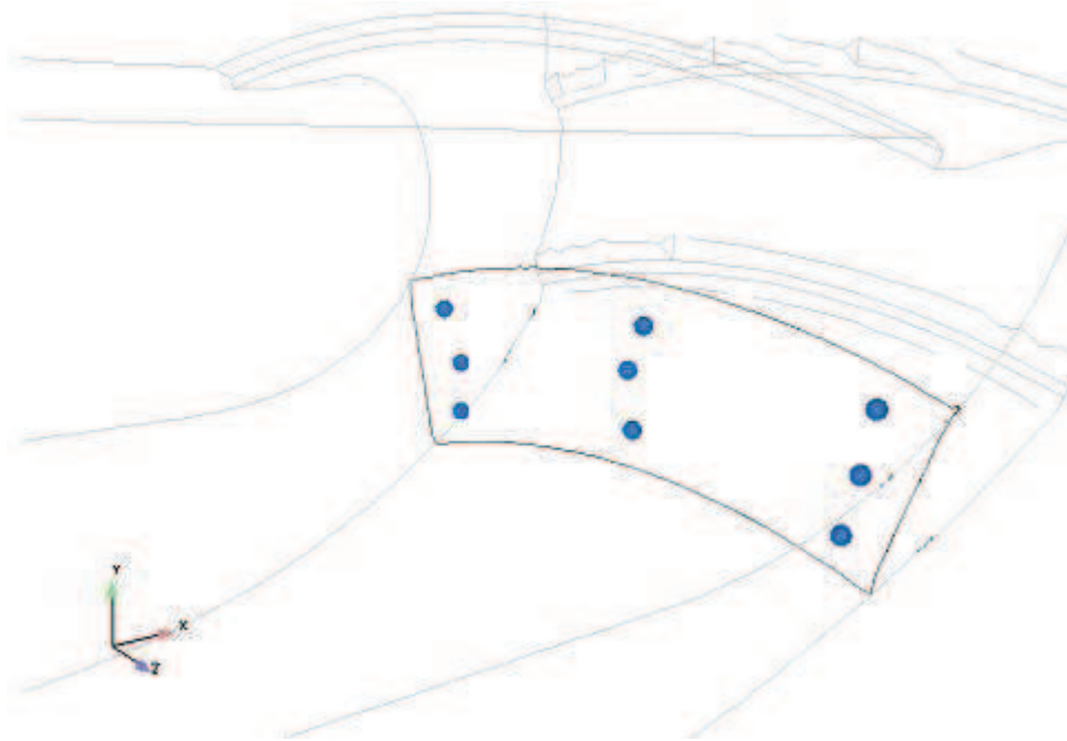
Figure VI-2 : points auxquels sont extraits la pression, la température et la vitesse lors de la simulation LES
