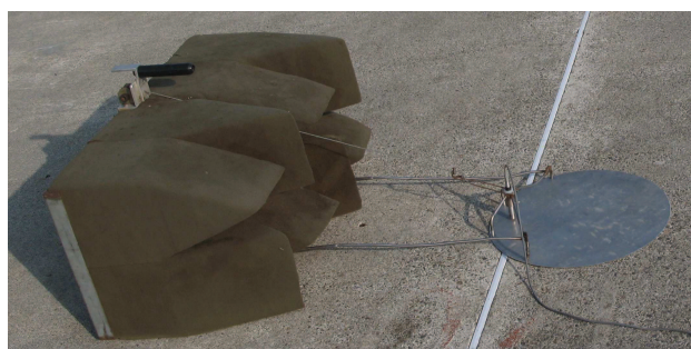
Figure III-3 : vue du microphone au sol avec son support
