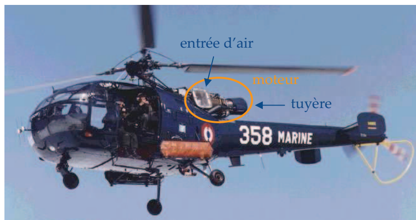
Figure I-1 : intégration du moteur sur une Alouette (pas de capotage)
