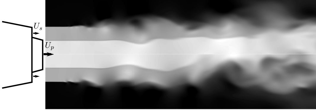
Figure I.3 – Champ de vitesse axiale instantané issu d'un calcul LES sur un jet double-flux en sortie d'une tuyère coaxiale, calcul réalisé par Vuillot et al. [2008].
