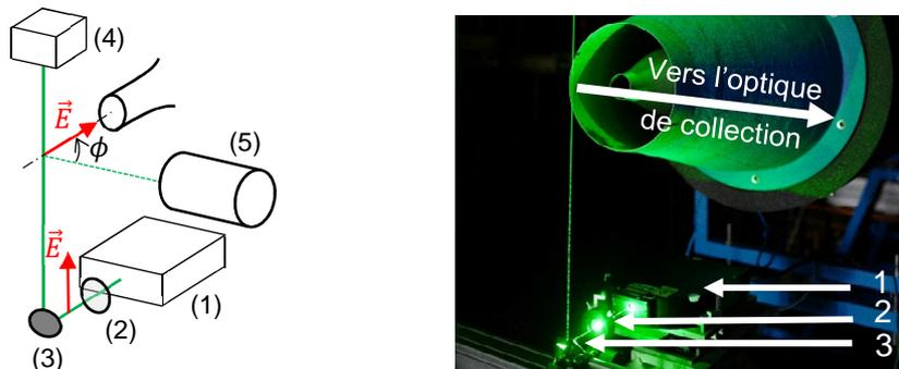
Figure 1 : Schéma et photo du dispositif optique pour la diffusion Rayleigh. (1) Tête laser, (2) lame Demi-onde, (3) Miroir plan, (4) piège à faisceau, (5) optique de collection
