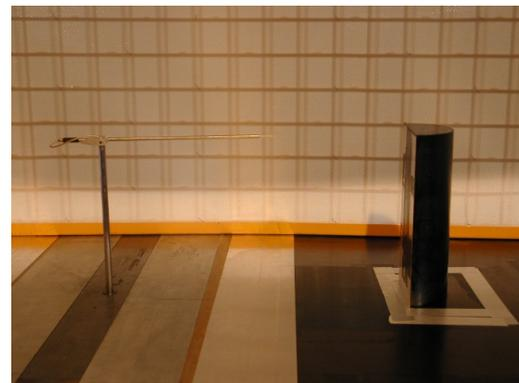
**Fig. 4.10** – Montage du fil chaud en aval du demi-cylindre. Le fil chaud est monté sur un déplacement en  $x_2$  (portion en noir sur le plancher).
