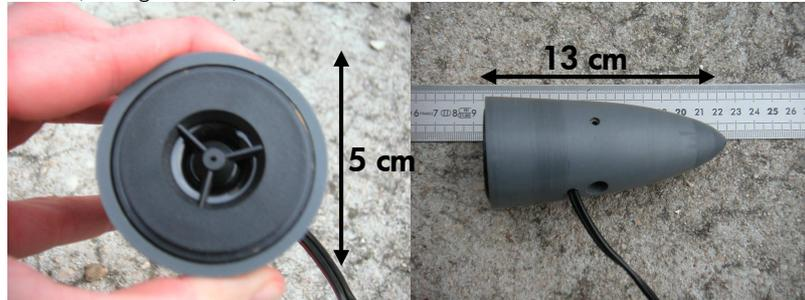
**Figure 5-4 : Carénage du tweeter Audax TW010F1.**
