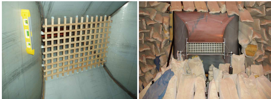
FIG. 1.13 – Vues de la grille de turbulence de l'intérieur de la veine à gauche et de l'extérieur à droite (soufflerie anéchoïque de l'ISVR).
