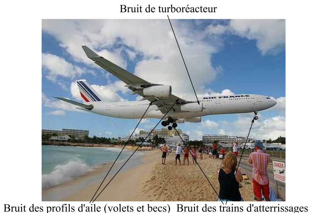
FIG. 1 – Sources de bruit d'un avion.
