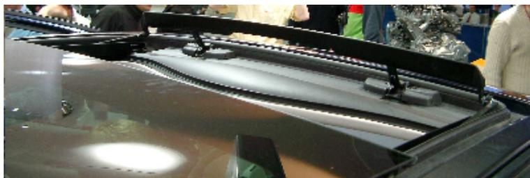
FIG. 1.25 – Photographie du déflecteur du véhicule D.
