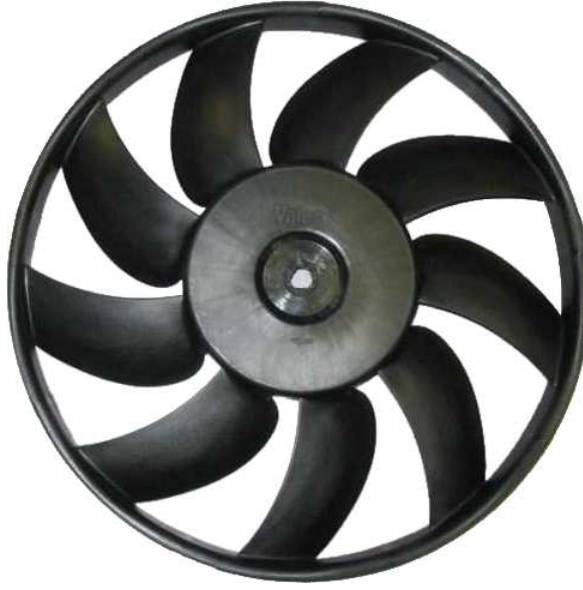
FIG. 5.18: Ventilateur axial de refroidissement automobile vu du côté de l'aspiration. Le ventilateur tourne dans le sens horaire (pales déversées vers l'avant).
