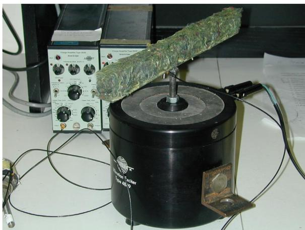
Figure 3.18: Appareil de mesure du module d'Young : poutre d'Oberst, d'après rapport IMPACT [4]
