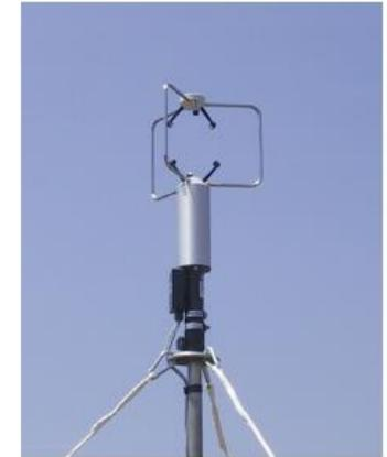
FIGURE: Anémomètre ultrasonique tridimensionnel.
