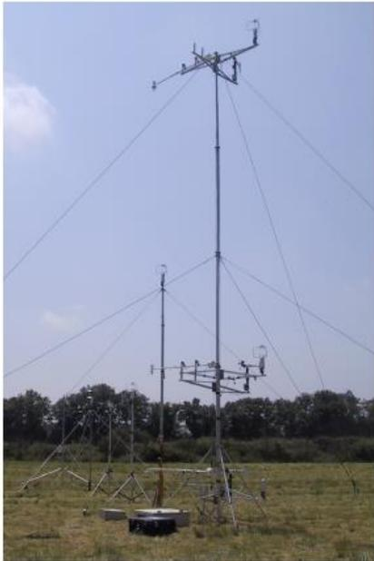
FIGURE: Mât équipé de capteurs météorologiques sur trois hauteurs (1, 3 et 10 m).
