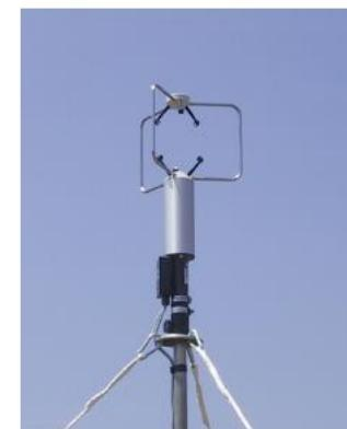
FIGURE: Anémomètre ultrasonique tridimensionnel.
