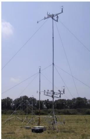
FIGURE: Mât équipé de capteurs météorologiques sur trois hauteurs (1, 3 et 10 m).
