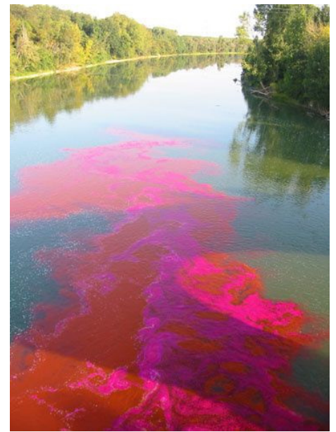
Suivi de la propagation d'une nappe de pollution (simulation avec fluorescéine et Rhodamine B) sur la Garonne (2008) https://www.smeag.fr/
